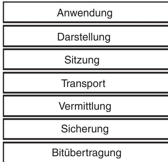
Abbildung A.1: Die sieben Schichten des OSI-Modells
